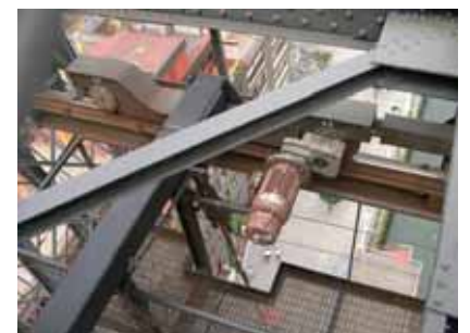
動力の変更ー車輪ごとに独立したモーター
