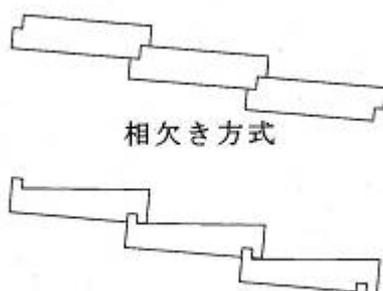
図-2 橋板の継目方式
